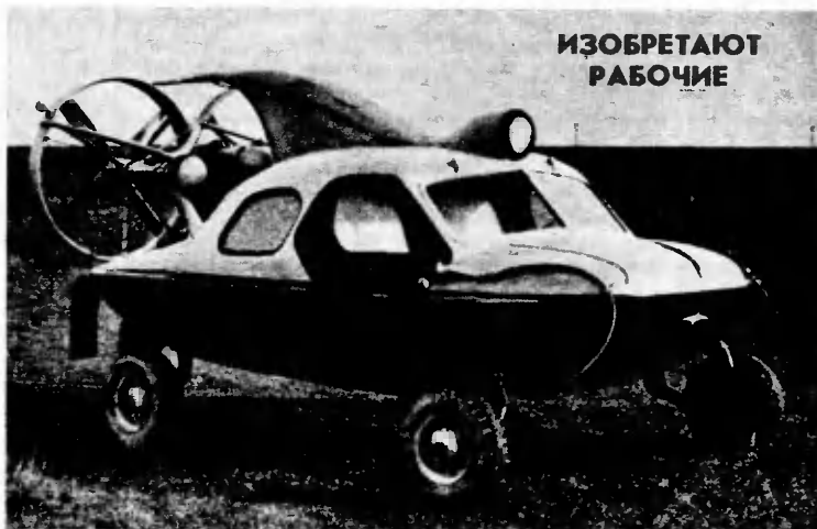
Если на аэровездеход поставить автомобильный двигатель, общий вес получится полтонны, грузоподъемность такая же. Размеры машины 3,5×2,0×1,8 м.
